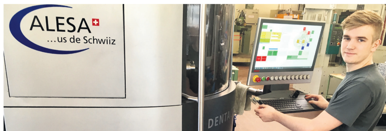
Cedric Haller, Polymechaniker im 4. Lehrjahr, bedient die neue, von der ALESA Maschinen AG entwickelte und gebaute Schleifmaschine. Die Maschine schleift Kreissägen aus HSS (High Speed Steel: Hochgeschwindigkeitsstahl) und Vollhartmetall mit einem Durchmesser von 40 - 160 Millimetern. (Bild: hzh)
